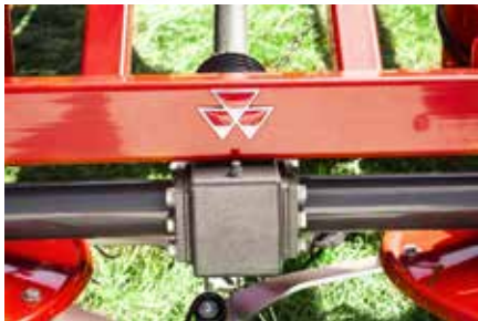
Låg ägandekostnad och enkelt underhåll tack vare underhållsfria dubbla knutkors och enkel åtkomst till ledernas smörjnipllar och oljefyllda växellåda.
